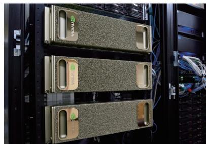
TensorコアGPU「NVIDIA V100 Tensor」を8基搭載し、NVIDIAの次世代バス規格「NVIDIA NVLink」を採用したAIサーバー。CPUには「Intel Xeon E5-2698 v4」を2基搭載し、512GB メモリ、1.92TB SSDを4基、ネットワークは、NFS用に10Gb ×2とノード間接続間のためにIB EDRx4も標準実装されている。
