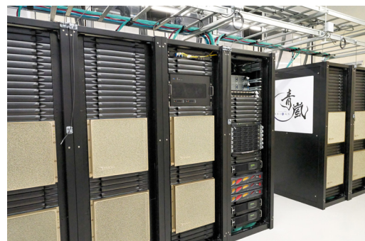
「NVIDIA DGX B200」×12台で構成されたAIスーパーコンピュータ「青嵐」
