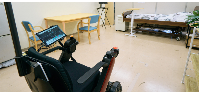
居住環境を再現した実証空間と車椅子型の人協調型ロボット
